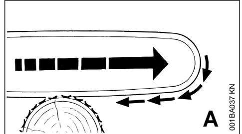
Si lorsqu'on coupe avec le côté inférieur du guide-chaîne – coupe sur le dessus – la chaîne se coincé ou touche un corps étranger noyé dans le bois, la tronçonneuse peut être brusquement attirée vers le tronc – **pour éviter ce phénomène, toujours fermement appliquer la griffe contre le bois à couper.**
