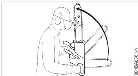
En cas de rebond (kick-back), la tronçonneuse est brusquement projetée vers l'utilisateur en décrivant un mouvement incontrôlable.
