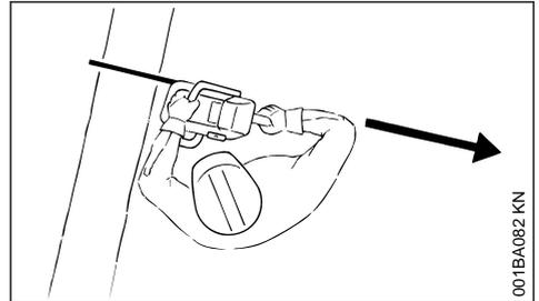
Tenir la tronçonneuse de telle sorte qu'aucune partie du corps ne se trouve dans le prolongement du **plan de basculement** de la chaîne.
