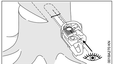
Si possible, utiliser la nervure de visée pour mortaisage. La nervure de visée pour mortaisage est parallèle au bord supérieur ou inférieur du guide-chaîne.
