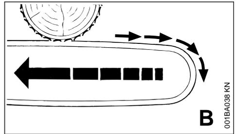
Si lorsqu'on coupe avec le côté supérieur du guide-chaîne – coupe par le dessous – la chaîne se coincé ou touche un corps étranger noyé dans le bois, la tronçonneuse peut être repoussée en arrière, en direction de l'utilisateur – **pour éviter ce phénomène :**
